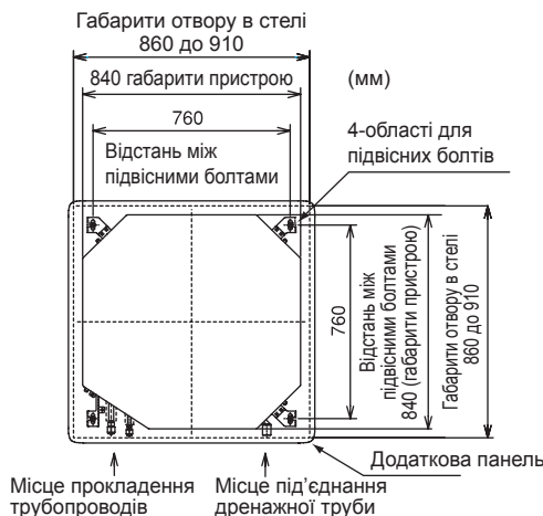
Мал 3.3 Отвір для декоративної панелі та місце підвісних болтів
